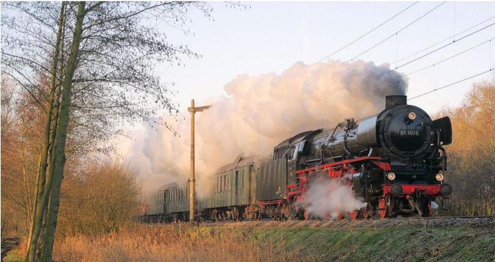
„Gebaut wurde die stromlinienförmig verkleidete SchnellzugdampfloK 01 1066 im Jahr 1940 von der BMAG (Berliner Maschinenbau Actien-Gesellschaft, vormals L. Schwartzkopff). Nach dem Ende des Zweiten Weltkrieges wurde die Stromlinienverkleidung entfernt. 1954 bekam die 01 1066 einen neuen Hochleistungskessel und 1957 erhielt sie eine Ölhauptfeuerung. So ausgestattet erbrachte die 140 km/h schnelle Lok Höchstleistungen.
